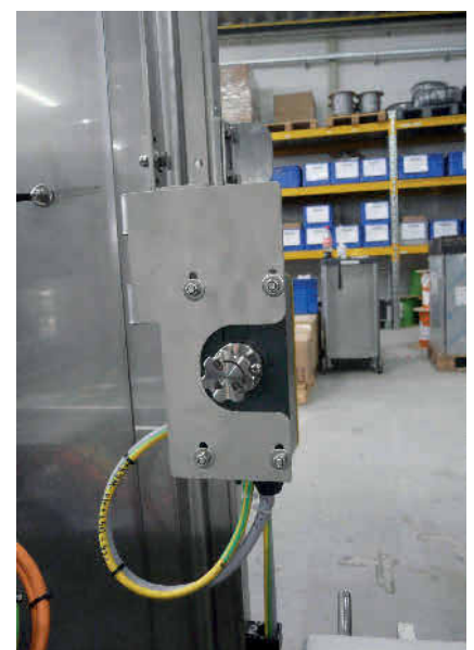
Bild 4 Die Fluchtentriegelung ist eine Option für den unwahrscheinlichen Fall, dass Personal im Gefahrenbereich eingeschlossen wird. Foto: steute
