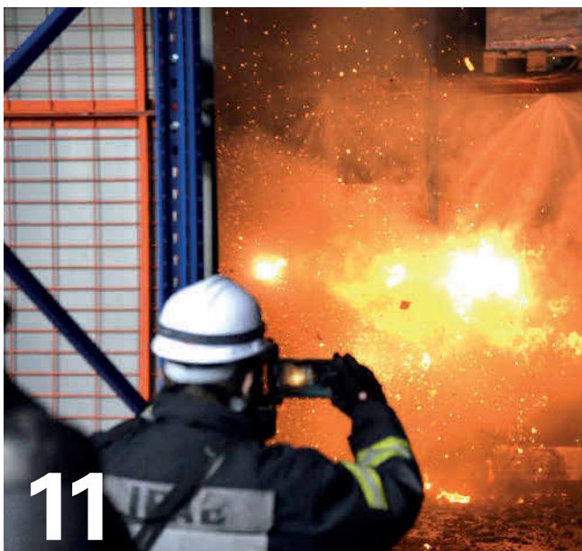
Großbrandversuche mit Lithium-Ionen-Batterien. Foto: Fogtec
