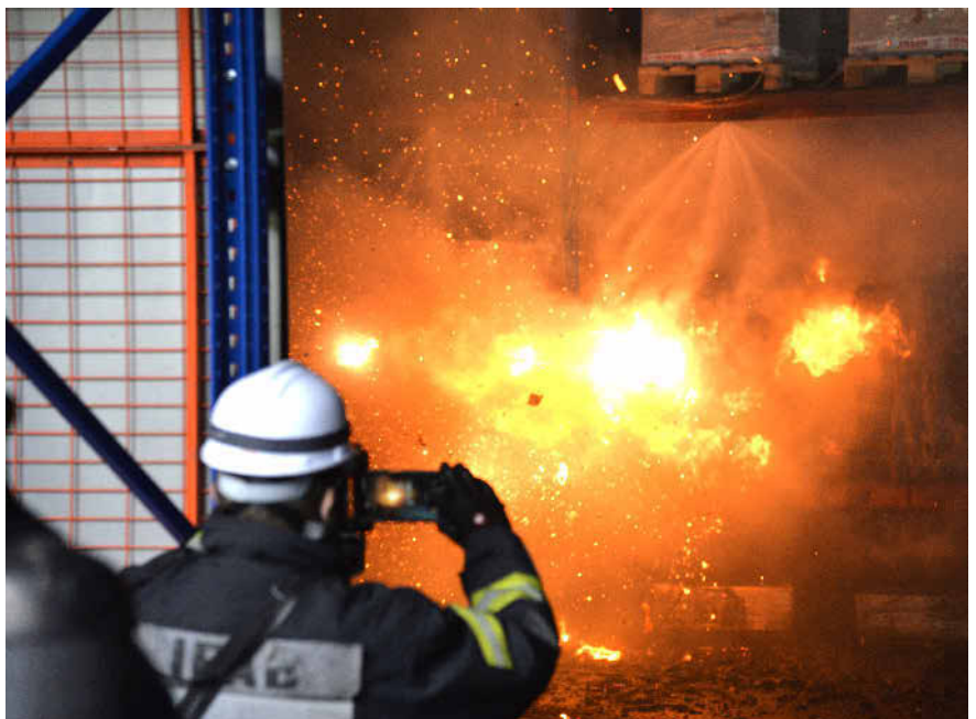
Großbrandversuche mit Lithium-Ionen-Batterien. Foto: Fogtec
