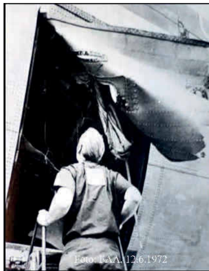
Bild 6 Ein Ingenieur der FAA untersucht die Reste der abgerissenen Frachtraumtür. Foto: FAA
